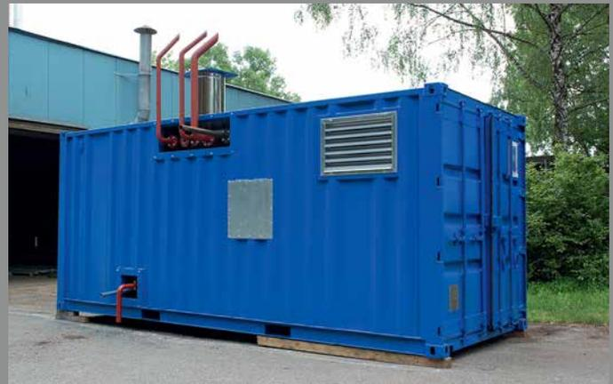
Hierbei handelt es sich um unsere bewährten Dampfcontainer – kompakte und betriebsbereite Dampfanlagen, die einfach an einem passenden Ort aufgestellt werden. Sie decken einen Leistungsbereich von 500 bis 8.000 kg/h ab und sind mit Speisewasserbehälter, Wasseraufbereitung, Schornstein usw. ausgestattet. Leichtöl oder Erdgas dient als Energiequelle für die Befuerung.
